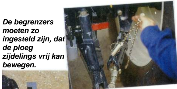
Voor het aanbouwen van de ploeg, worden de hefarmen op gelijke lengte ingesteld. Een duimstok is zeker nauwkeuriger dan een timmermansoog.
