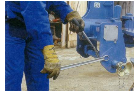
Bij Lemken kan de trekstang verdraaid worden voor de hoogte-verstelling. De vier bouten zijn snel weer vast gezet.
